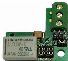
9135250D Zusätzlicher Relaiskontakt Offen / Geschlossen Option , zeitlich unbegrenzt bis 48V/ 2A.
